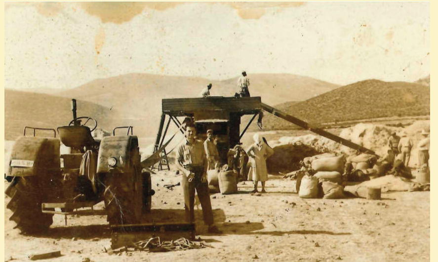
Πατόζα: μεγάλη μηχανή στάσιμη που δούλευε με την βοήθεια τρακτέρ. Ένας ιμάντας - λουρί μετέφερε την κίνηση από το τρακτέρ στην πατόζα. 1959 στο ζυγολόγιο ο Βασίλης Ν. Τράκος.
